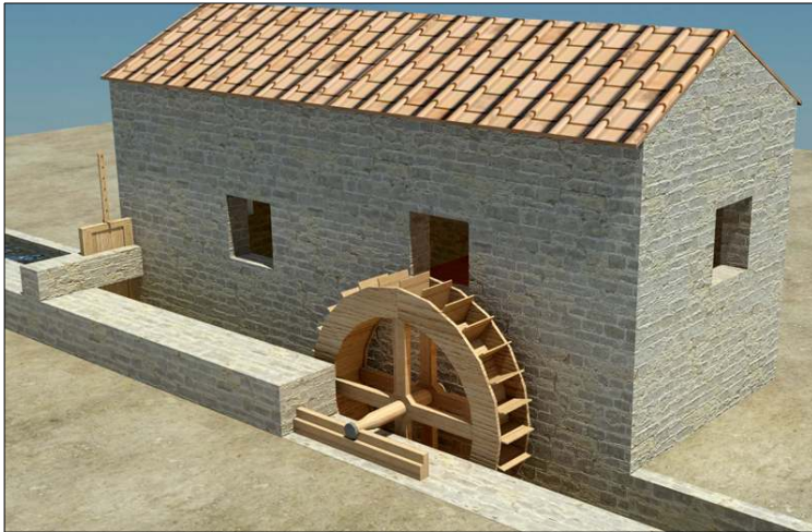
FIGURE 2 – Le moulin à eau décrit par Vitruve, vue extérieure (UCBN – Plan de Rome)
